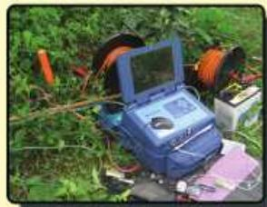
Seismic Refraction Survey
