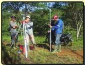
GPS Geodetic menggunakan RTK
