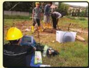
Seismic Downhole Survey
